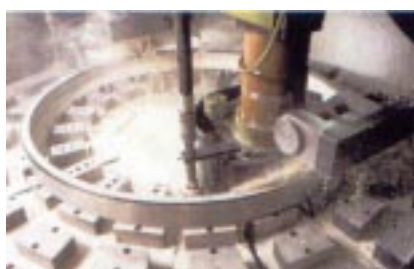
Szlifowanie bieżni pierścienia zewnętrznego
