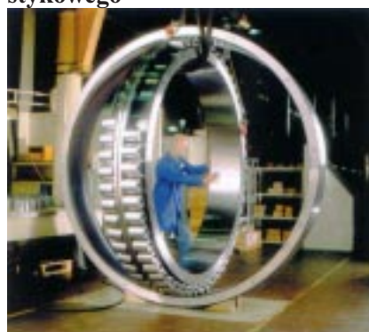
Montaż łożyska wielkogabarytowego
