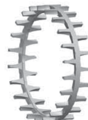
Rys. 8. Kosz jednoczęściowy typu palcowego z mosiądzu obrabionego maszynowo, prowadzony na pierścieniu wewnętrznym.
